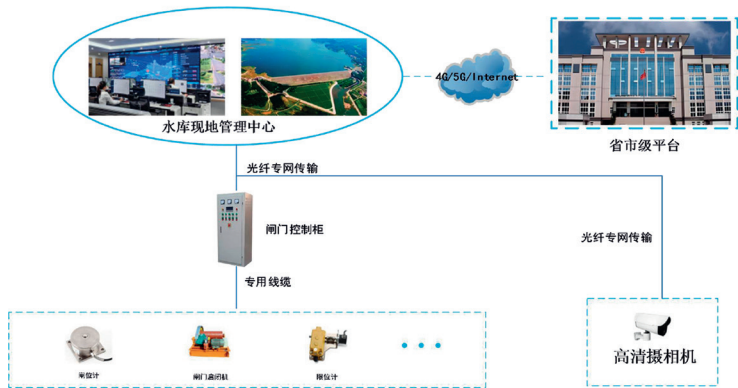
闸门控制系统拓扑图
